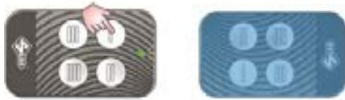
7. MIENTRAS EL LED PARPADEA, APRETAR EL BOTÓN DEL “AIR4” DÓNDE SE TIENE QUE TRANSFERIR EL CÓDIGO. MANTENER APRETADO HASTA QUE EL LED SE APAGUE.
