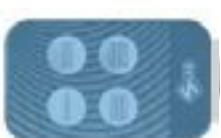
7. PENDANT QUE LA LED CLIGNOTE, APPUYEZ SUR LE BOUTON DU « AIR4 » SUR LEQUEL LE CODE DOIT ÊTRE TRANSFÉRÉ ET MAINTENEZ APPUYÉ JUSQU'À CE QUE LA LED S'ÉTEIGNE.
