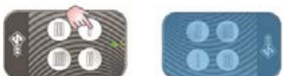
7. WÄHREND DIE STATUSLED BLINKT, JENE TASTE AN DER "AIR4" DRÜCKEN, WELCHE PROGRAMMIERT WERDEN SOLL. DIE TASTE SOLANGE DRÜCKEN, BIS DIE LED ERLISCHT.
