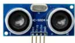
HC-SR04 - Ultrasonische afstandssensor
