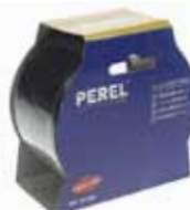
'Duct' Tape 48mm x 10m - Ideaal voor snelle herstellingen - Hoge weerstand tegen vocht, groot kleefvermogen, schuurvast - Kleefvermogen: 3,8N/inch - Treksterkte: 49N/inch
