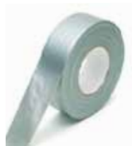
Grijze 'Duct' Tape 50mm x 50m - Ideaal voor snelle herstellingen - Hoge weerstand tegen vocht, groot kleefvermogen, schuurvast - Kleefvermogen: 16,5N/inch - Treksterkte: 115N/inch
