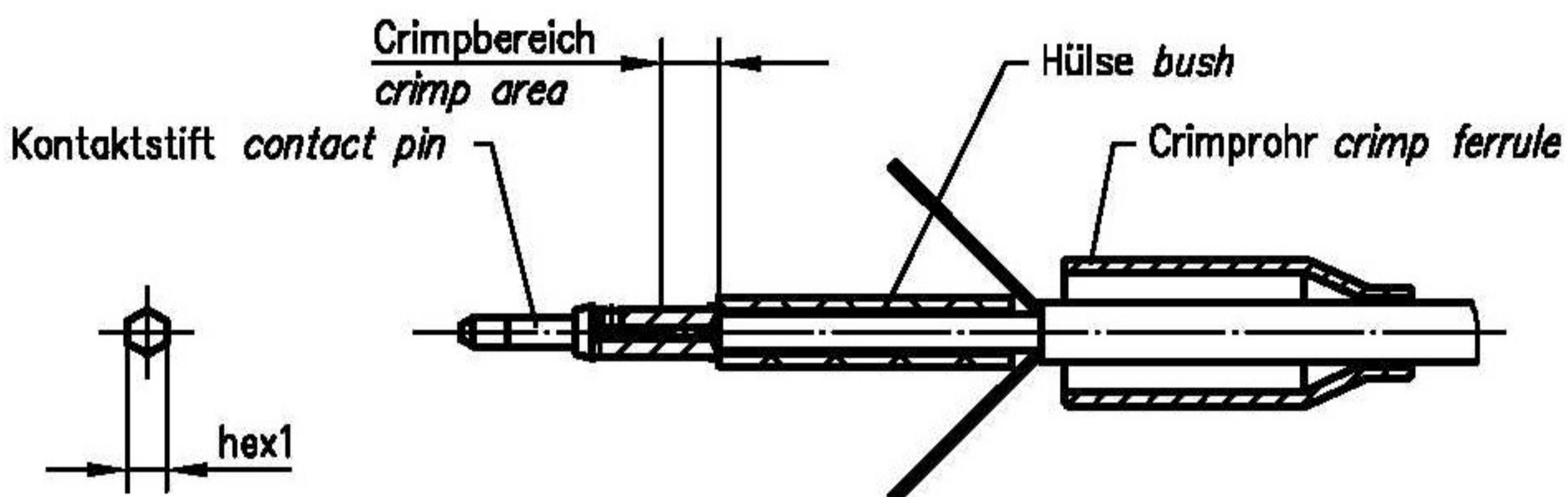
Kontaktstift mit der Hülse in das Gehäuse einschieben
